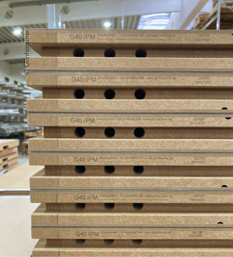
G40 IPM Wandelemente mit jeweils drei Verbindungsbohrungen G40 IPM wall elements with three connecting holes each
