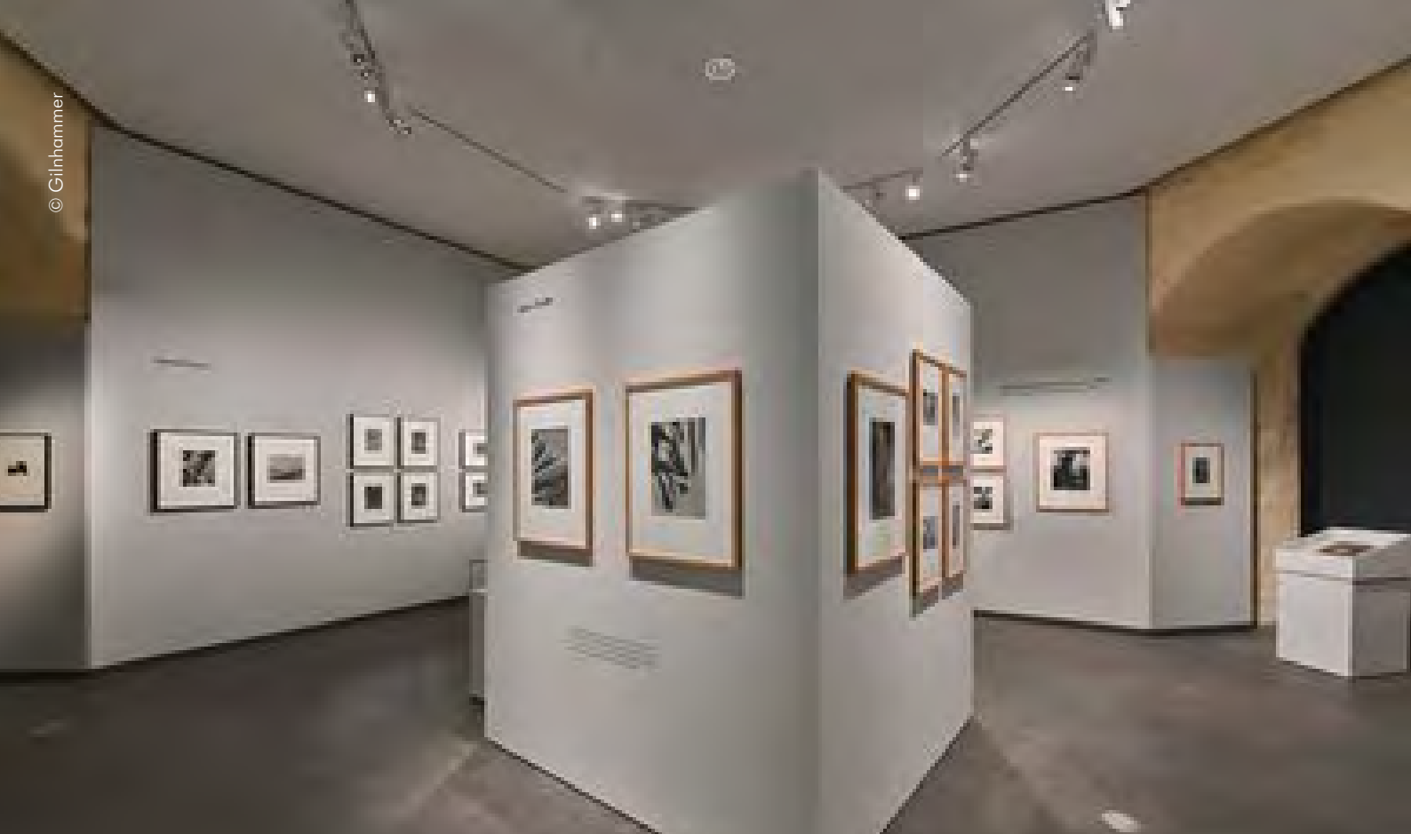
G40 CLASSIC Ausstellungswände, raumhoher Einbau, rohe Wände nach einbau gestrichen für maximale einheitliche Oberfläche G40 CLASSIC exhibition walls, floor-to-ceiling installation, raw walls painted after installation for maximum uniformity of finish
