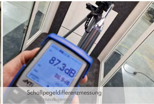
Probeaufbau und Schallpegeldifferenzmessung bei einer Modell ZWEI.62 RAUMBOX Test setup and sound level differential measurement for a model ZWEI.62 RAUMBOX
