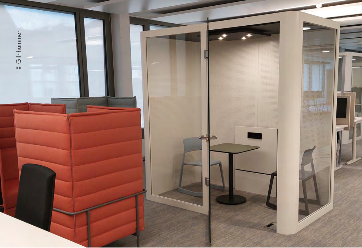
G40 RAUMBOX, Runde Ecken mit Aluminiumprofil, Modulbauweise G40 RAUMBOX, round corners with aluminum profile, modular design
