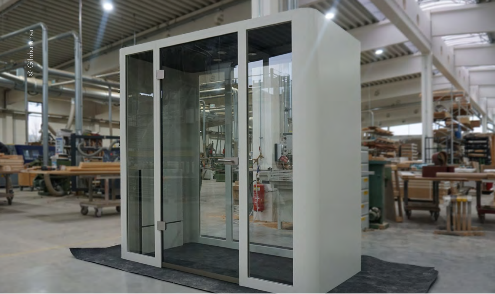
Probeaufbau und Schallpegeldifferenzmessung bei einer Modell ZWEI.62 RAUMBOX Test setup and sound level differential measurement for a model ZWEI.62 RAUMBOX
