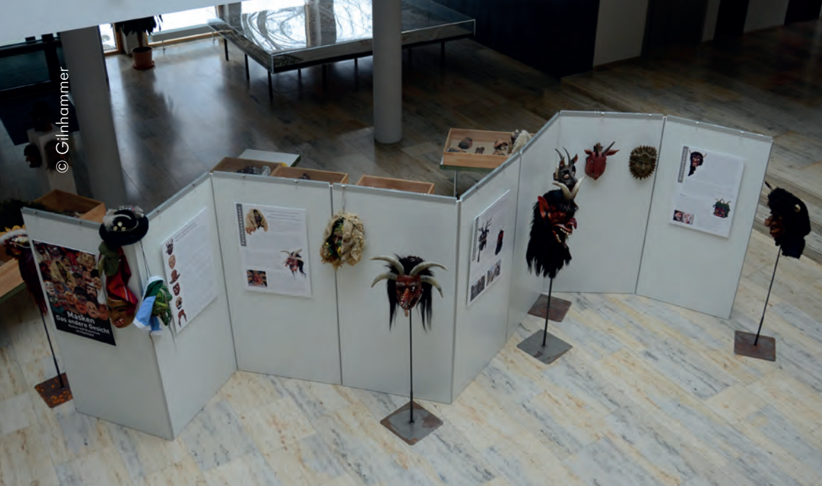
G19s Leichtbauplatten, werkzeuglos im Zickzack aufgebaut. G19s lightweight construction panels, assembled in zigzag shape without tools.
