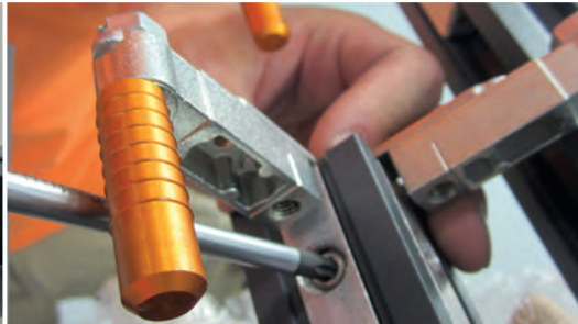
Die Eckverbindungen wurden mit den neu für das G40 CLASSIC Wandsystem entwickelten Dockverbindern verbunden. The corner connections were connected to the new Dock connectors developed for the G40 CLASSIC wall system.
