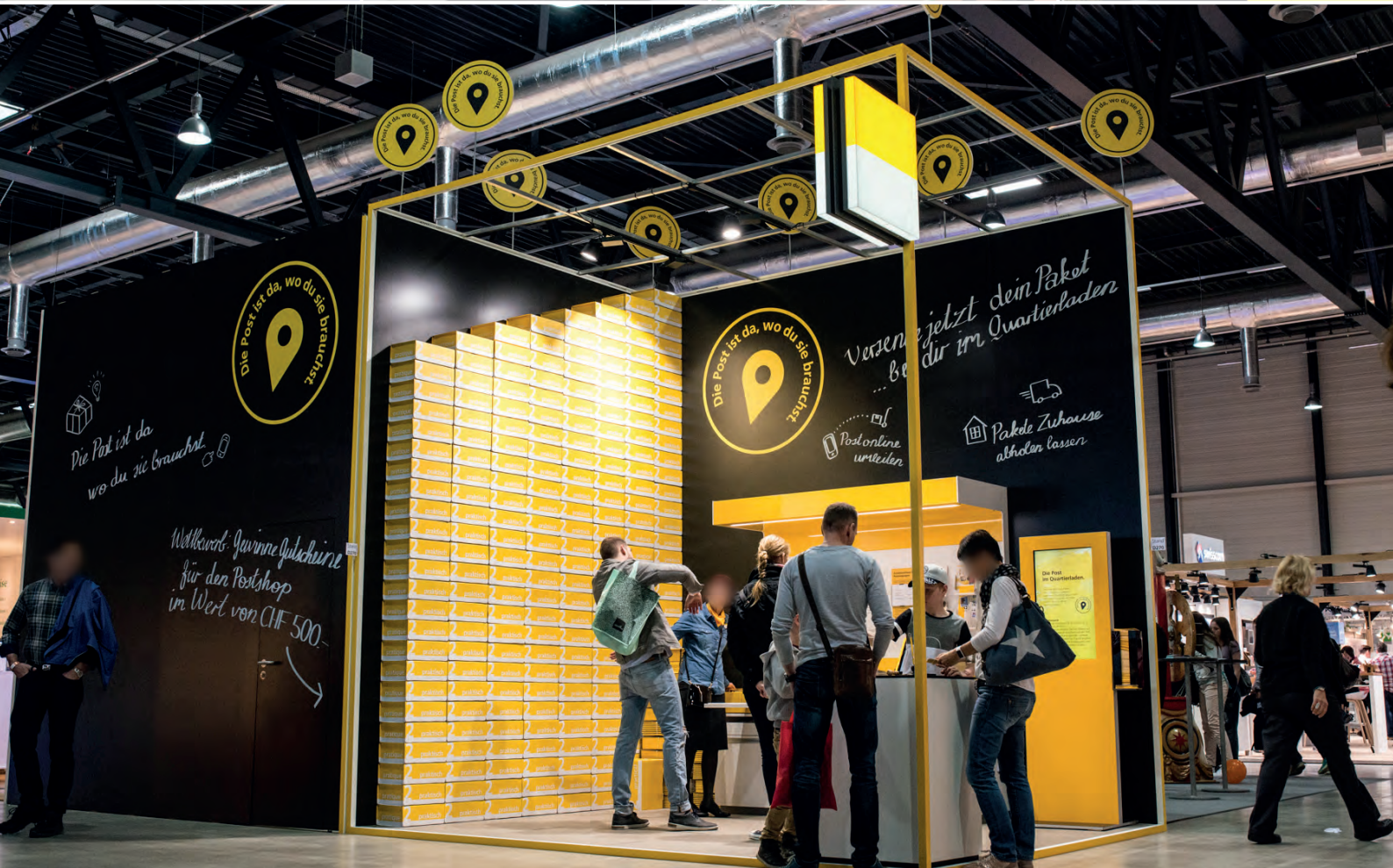
Rahmenkubus aus G40C DOCK-Profilen, Wände im G40 CLASSIC Wandsystem, magnetisch, Kabine mit Türe. Wandhöhe 2500mm plus 1500mm Aufsatzwände. Frame cube from G40C DOCK profiles, walls in the G40 CLASSIC wall system, magnetic, cabin with door. Wall height 2500mm plus 1500mm top walls.
